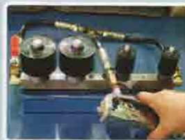
오일씰 구리스 주입 Inject grease in the oil gap
